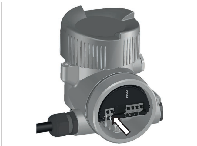
插图. 15: 连接步骤 5 和 6 - 双腔式壳体
